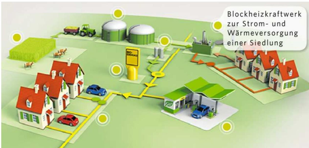
Abb. 3: Integration Biomethan-Blockheizkraftwerk und weitere Verwendungen (Heizung, Tankstelle) - Prinzipschema
