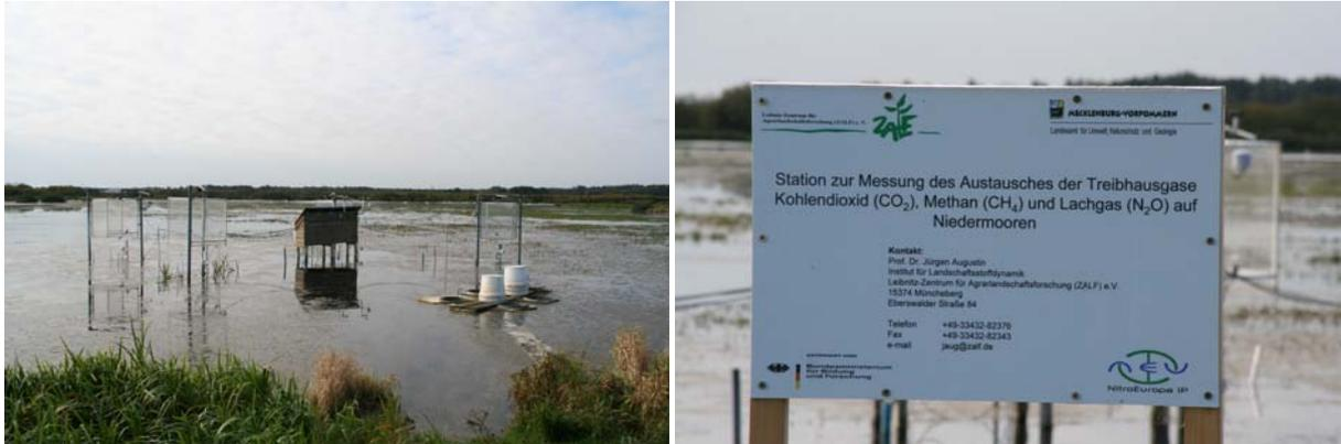
Abbildung 9: Station zur Messung des Treibhausgasaustausches im Polder Zarnekow-Upost, Peenetal
