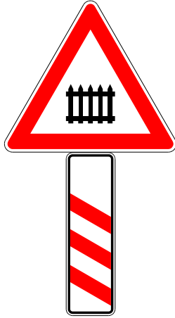
dreistreifige Bake (links) - vor beschränktem Bahnübergang -
