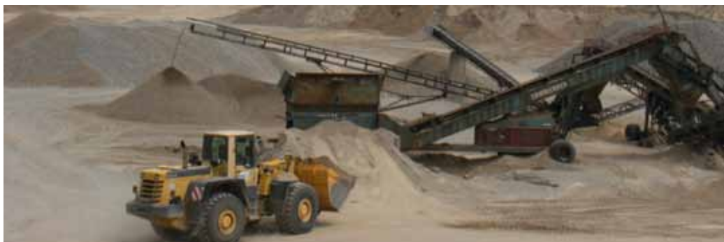
Abb.1: Kiesgewinnung und Klassieranlage Foto: Bergamt Stralsund
