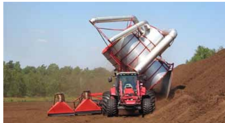
Abb. 7: Torfgewinnung im Tagebau Gölde- nitz Foto: Rostocker Humus & Erden GmbH
