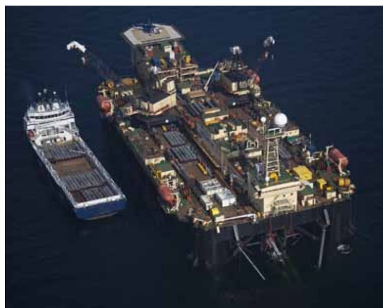
Abb.4: Die „Castoro Sei“, ein Verlegeship der zweiten Generation, führt die Verlegearbeiten im Bereich der Pommerschen Bucht durch / Foto: Nord Stream AG
