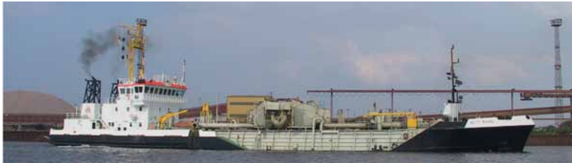
Abb. 2: Kiesgewinnung in der Ostsee mittels Laderaumsaugbagger Foto: Heinrich Hirdes GmbH
