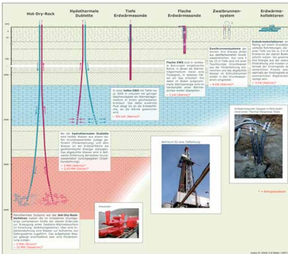
Abb. 1: Geothermische Nutzungssysteme (aus Stober et al. 2009)
