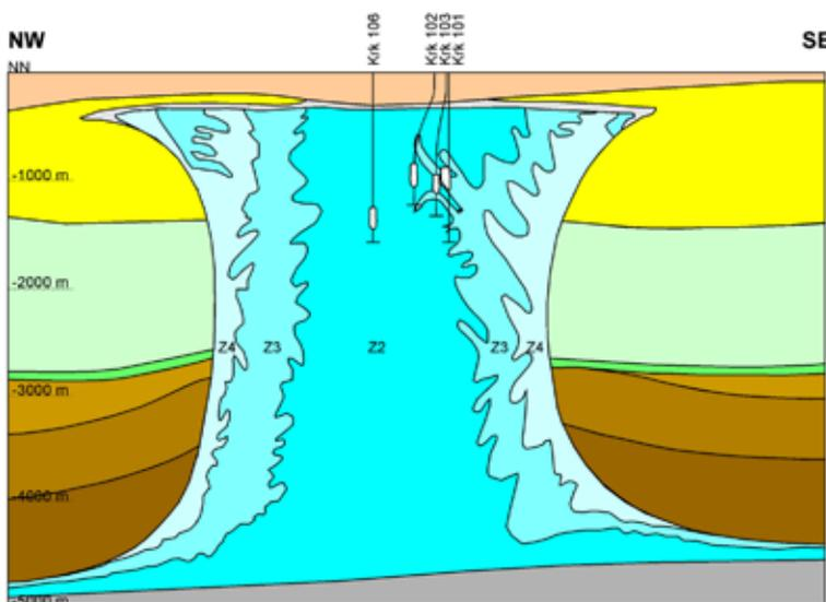
Abb. 1: Schematischer Schnitt durch den Salzstock Kraak
