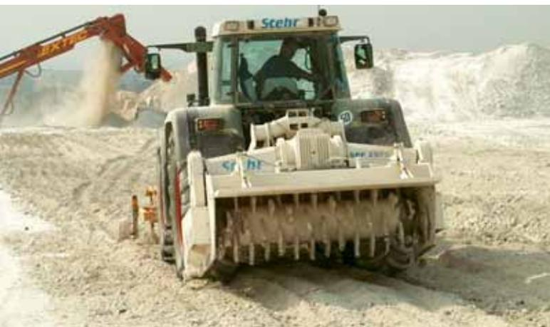
Abb. 6: Kreidegewinnung durch Oberflächenlockerung
