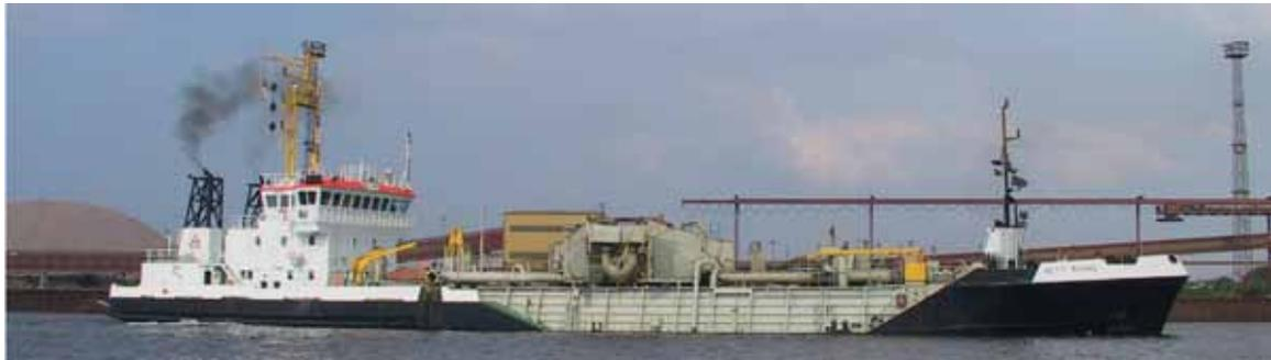
Abb. 2: Kiesgewinnung in der Ostsee mittels Laderaumsaugbagger
