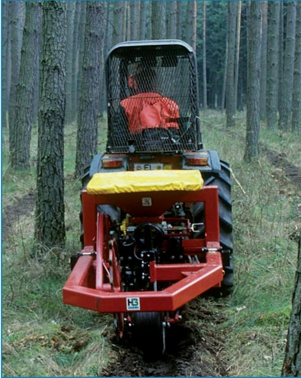
**Foto 5:** Sämaschine (Typ SÄGRIMM MV) zur Einbringung von Laubbaumsamen (z. B. Bucheckern) in zuvor angelegten Frässtreifen.
