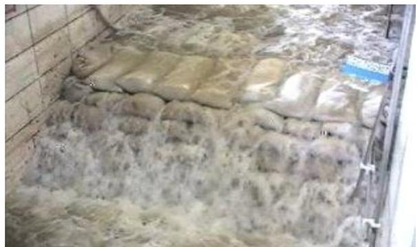
3.1.1 Versuche mit Geotextilsäcken im Großen Wellenkanal Hannover (OUMERACI ET AL., 2002).
