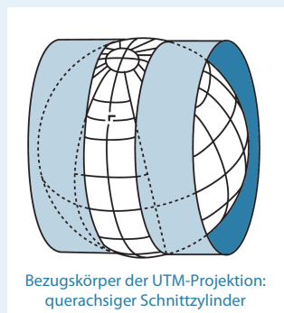
◀ UTM – Universale Transversale Mercatorprojektion: Abbildungsvorschrift für das amtliche geodätische Lagebezugssystem in M-V.
