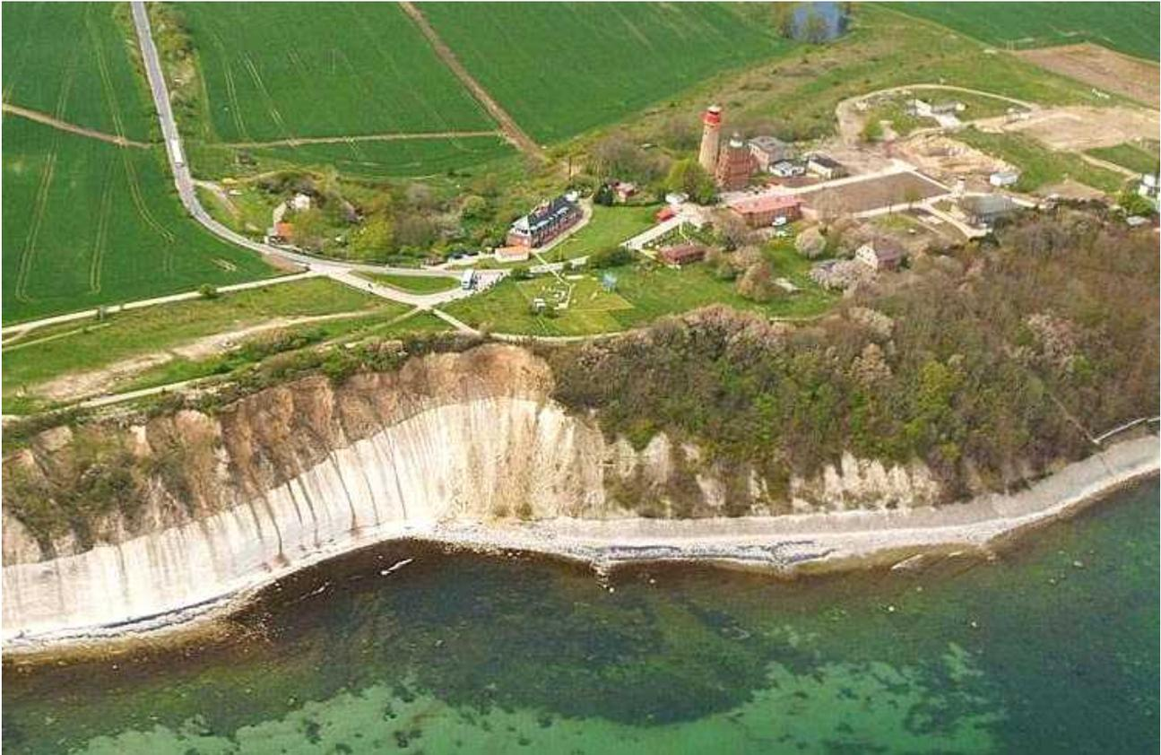
3.3.3. Durch eine Küstenschutzanlage (Deckwerk) inaktivierte, bewachsene Steilküste vor Arkona auf Rügen mit sich anschließender aktiver Steilküste.
